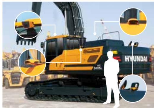
\* AVM (monitoreo de vista 360°): Asegura el campo de visión en todas las direcciones mediante nueve vistas, incluyendo la vista de pájaro en 3D y la vista 2D/4CH.
